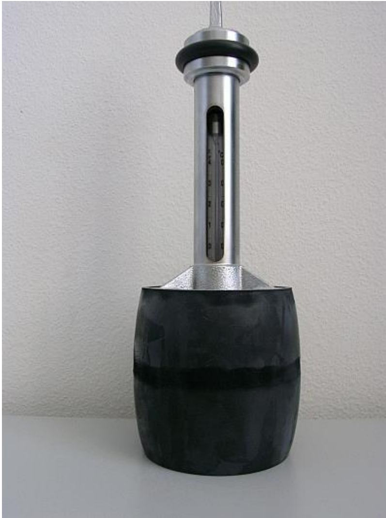
DWD sea surface temperature measurement instrument (photo Deutscher Wetterdienst)
